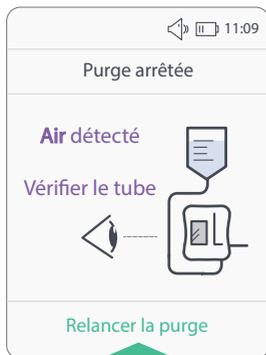
De l'air a été détecté dans la tubulure. Vérifier la tubulure pour trouver la source du problème :
